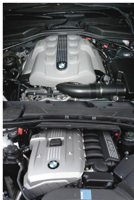
1. ábra: ha a motorháztető fedelét felnyitjuk, az ún. design burkolaton, hosszirányban középen egy dudort figyelhetünk meg; ha ilyet látunk, biztosak lehetünk benne, hogy első vagy második generációs Valvetronic (ejtsd: vélvtrónik) szelepvezérlésű a motor
