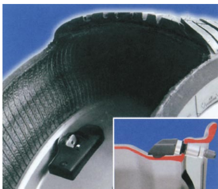
1. ábra: az aktív rendszereknél az elektronika legtöbbször a szeleppel van egybeépítve
