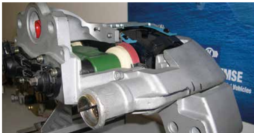
12 A Knorr-Bremse tárcsafék nyomótag külső és belső tömítései a fényképen egymástól jól elkülöníthető piros és fehér színűek.
