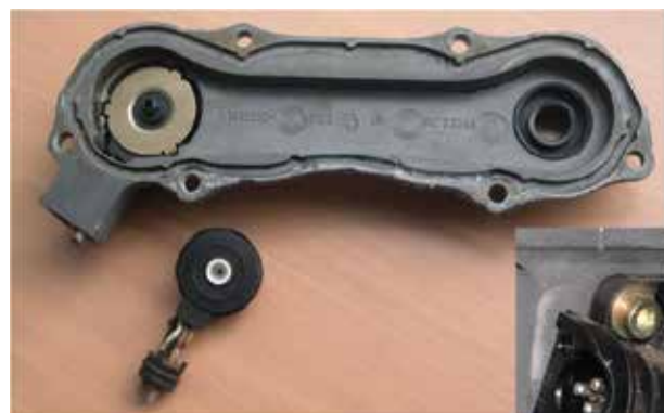
11 Az utánállító fedelébe szerelt potenciométeres kopásérzékelő és elektromos csatlakozója.
