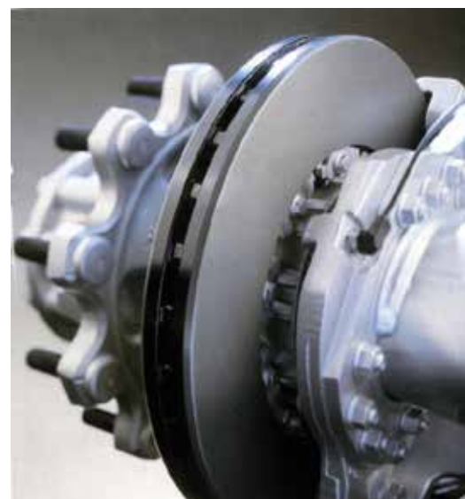
18 Knorr-Bremse Vmz típusú osztott, sík féktárcsa DAF CF hátsó futóművén.
