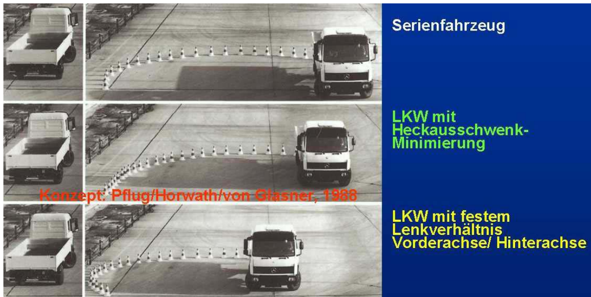
Bild 22: Steer-by-Wire - Hinterachszusatzlenkung
